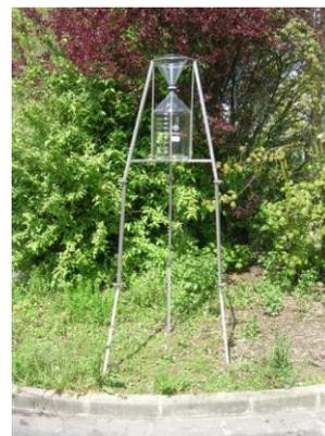
Figure 4 : jauge de prélèvement des retombées atmosphériques (en verre)
